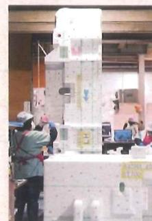
発泡スチロールで型を製作し、砂に埋め込む。流し込まれた溶湯の熱で気化し、工作機械の部品などの鋳物ができる
